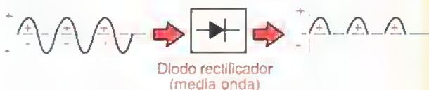
Figura 7.31. Acción básica de un diodo rectificador (media onda)
